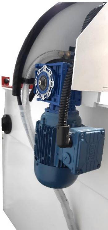
**Carro de afilado** accionado por un motor con reductor de tornillo sinfin y una rueda de arrastre con recubrimiento de goma para evitar la transmisión de vibraciones durante el ciclo de afilado.
